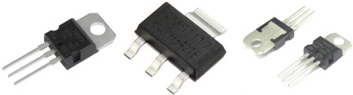
Figura 14 – Reguladores de tensão de 12V para +5V, 3,3V e -5V, respectivamente
