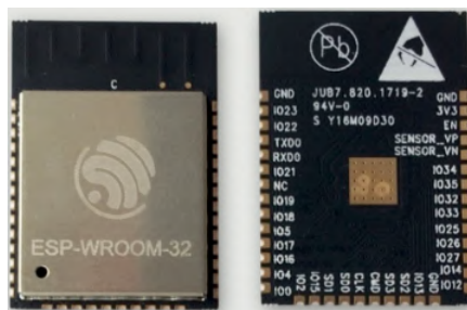
Figura 8 – Microcontrolador do dispositivo de monitoramento micro sísmico
