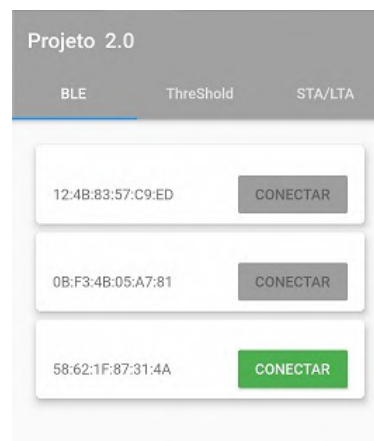
Figura 23 – Aplicativo de parametrização do dispositivo de monitoramento micro sísmico via Bluetooth
