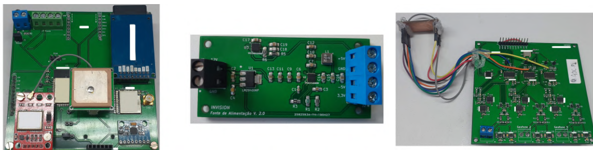
Figura 27 – PCBs dos módulos que compõem o dispositivo de monitoramento microssísmico soldados
