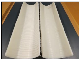
(a) Amostra da esquerda (1) foi fletida no carretel, a da direita (2) sem sofrer flexão alguma devido ao dobramento no carretel
