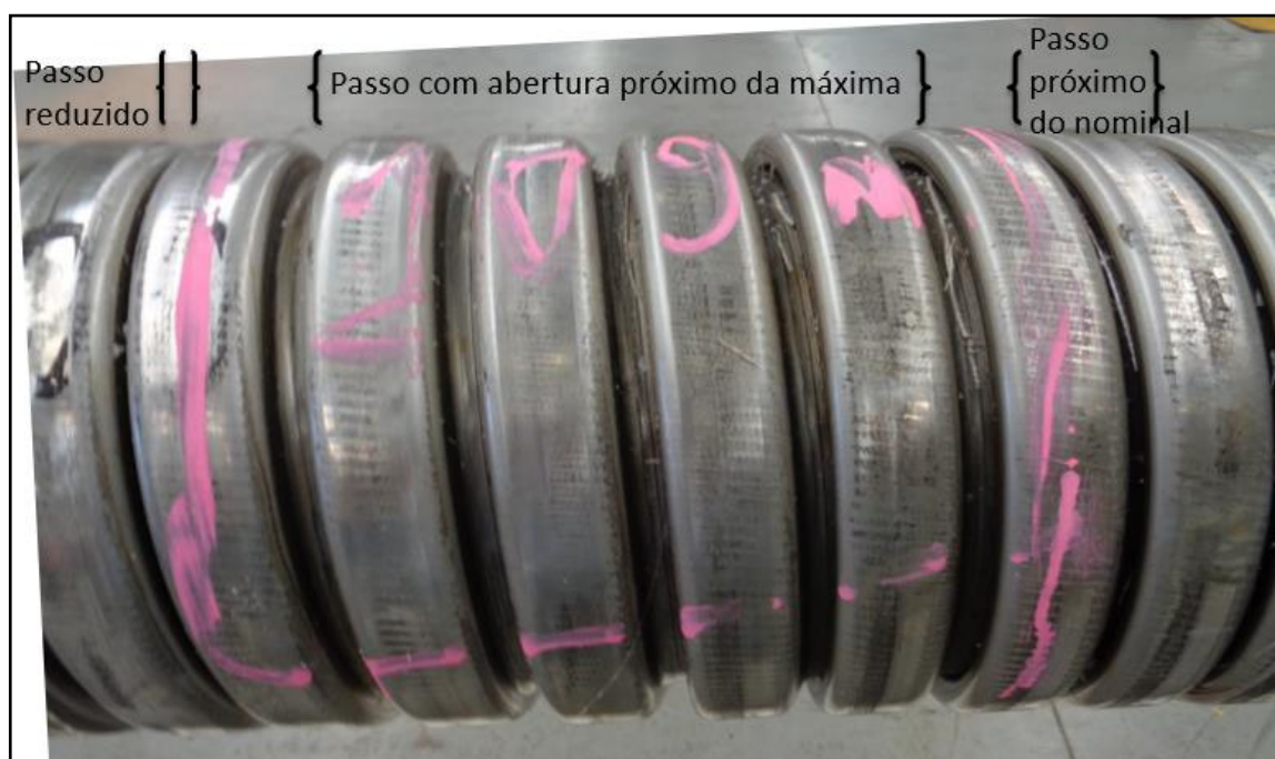
Figura 15 – Variação de passo em uma carcaça de duto flexível Fonte: Imagem cedida por NOVFlexibles
