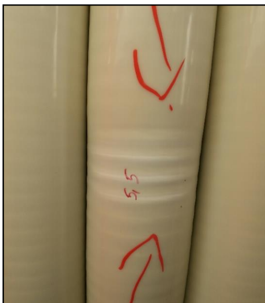
Figura 12 – Branqueamento do revestimento interno de uma linha flexível. Fonte: NOVFlexibles, (2008)
