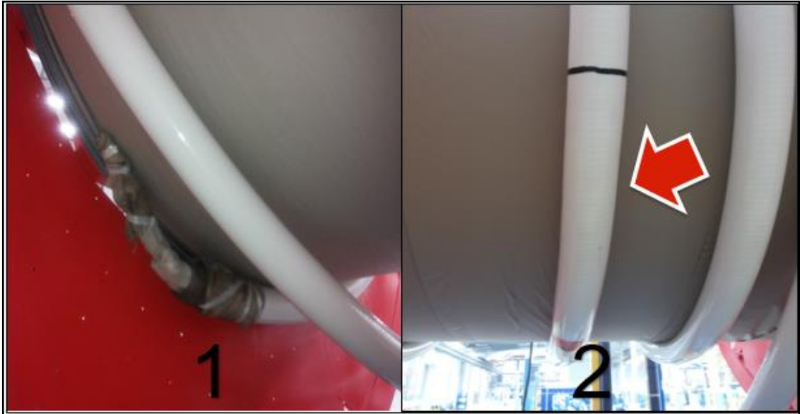
Figura 13 – Ocorrência de branqueamento durante o enrolamento do duto no carretel. Fonte: Imagem cedida por NOVFlexibles
