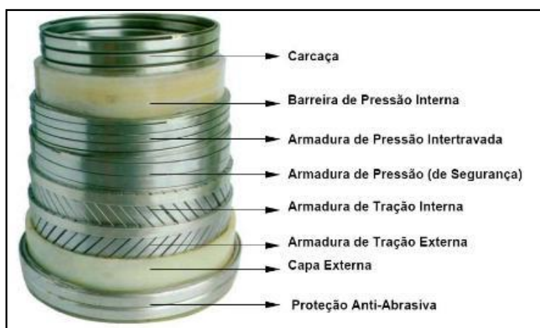
Figura 1 – Camadas que compõem um duto flexível Fonte: SILVA (2010)
