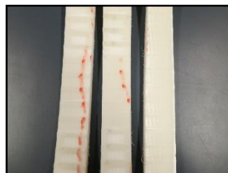
(b) As amostras da direita para a esquerda são tensionadas na máquina de tração a 0%, 3,5% e 5,25%, respectivamente, sem deformação inicial no carretel.
