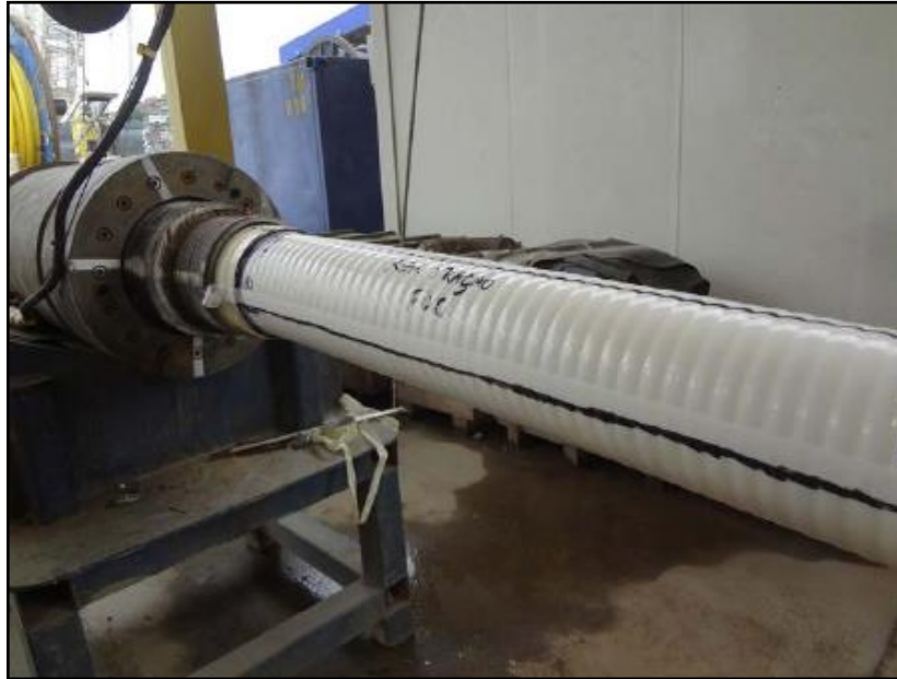
Figura 3 – Barreira de Pressão de PVDF em um tubo Flexível Dissecado. Fonte: Abreu (2012)
