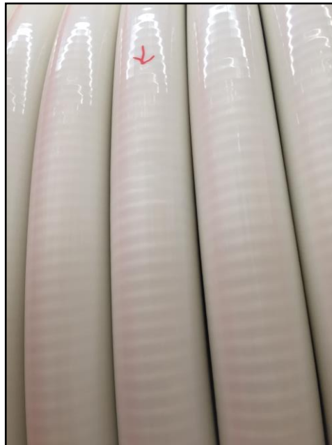
Figura 14 – Aparecimento de branqueamento ao longo de todo o comprimento do duto na camada mais próxima ao núcleo do carretel. Fonte: Imagem cedida por NOVFlexibles
