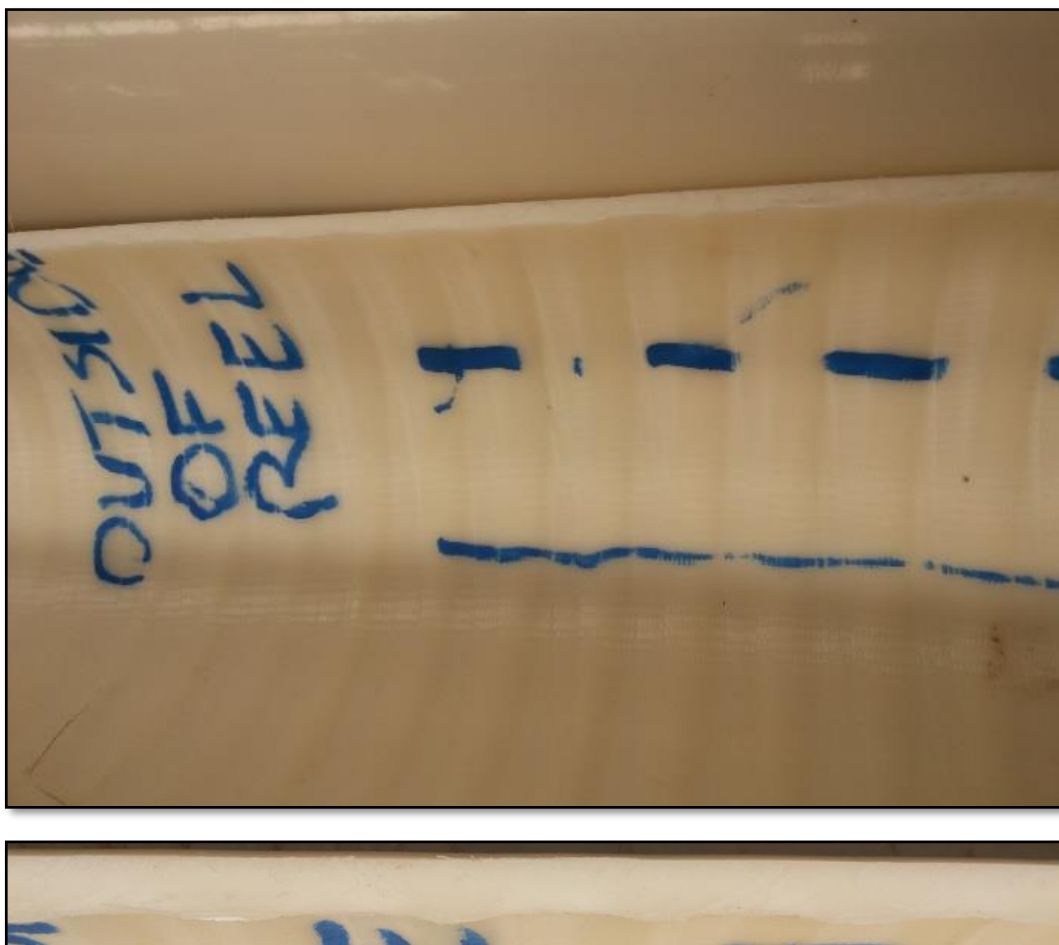
Figura 26 - Características visuais do branqueamento da amostra #02: camada em PVDF manufaturado sobre carcaça (acima); perfil da amostra removida (abaixo).
