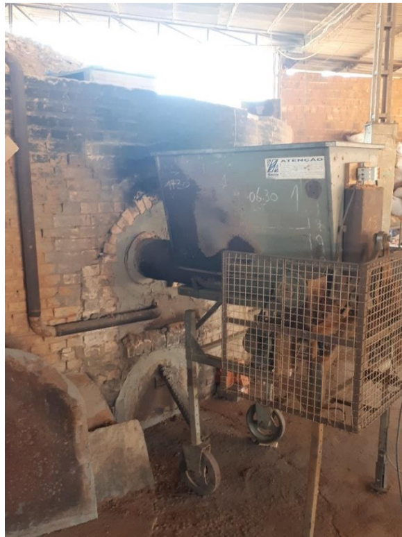
Figura 26- Máquina de pó de serra conectada a uma das fornalhas Fonte: Autor (2018)
