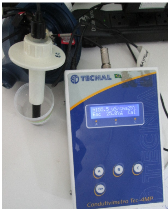
Figura 15: Sensor e aparelho para calibração Fonte: Elaboração própria
