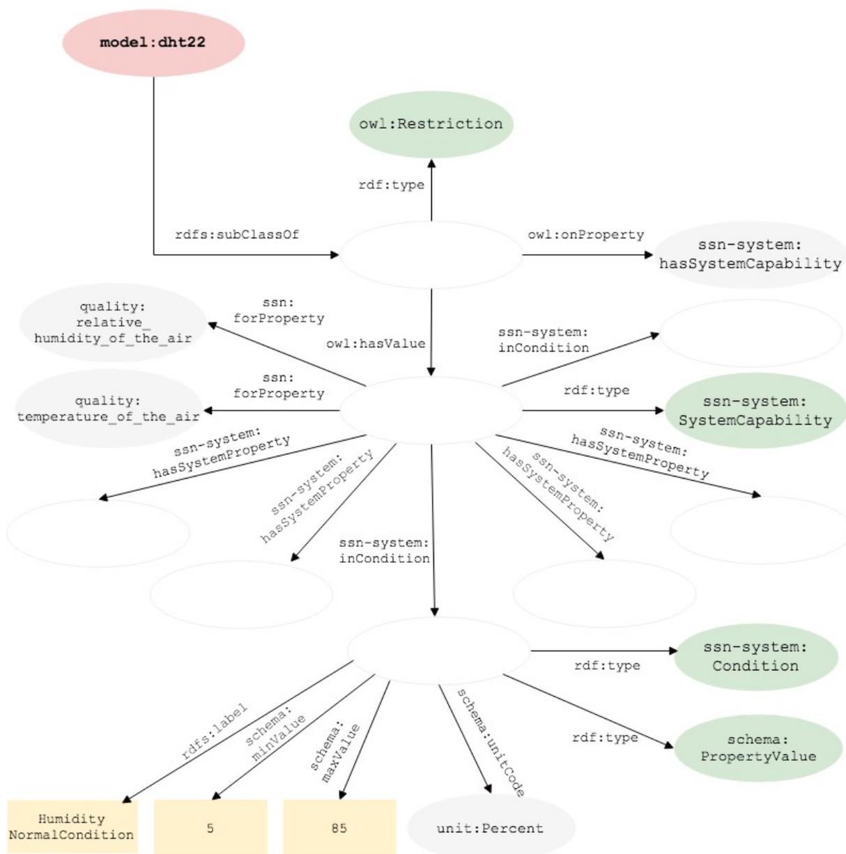
**Figura 94-** Parte do grafo RDF subjacente ao cadastro do modelo DHT22 com foco na capacidade de sistema e sua condição de umidade
