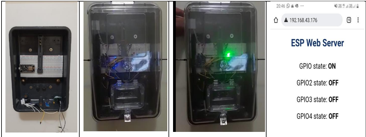
Figura 41: Teste conjunto sensores com montagem na caixa
