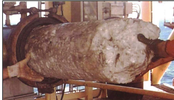
Figura 22: Plug de hidrato formado em uma tubulação bloqueando a mesma. Fonte: Tohidi (2017, p. 10)
