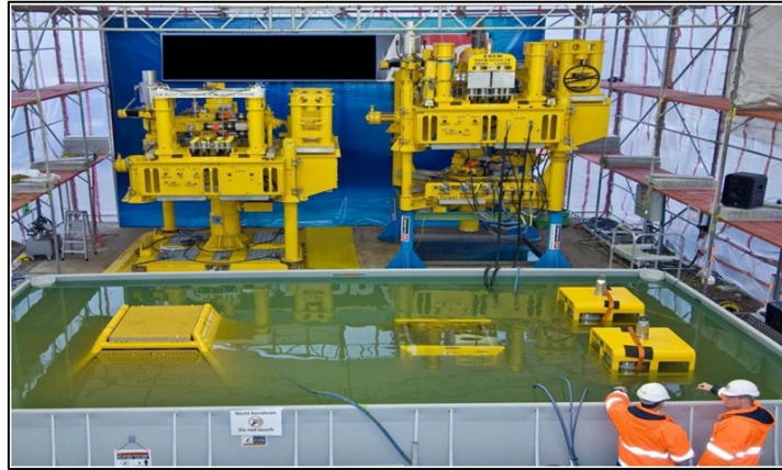
Figura 20: Duas ANM's totalmente elétricas durante testes na Alemanha. Fonte: Schwerdtfeger, Scott e Chakkungal (2017, p. 5).
