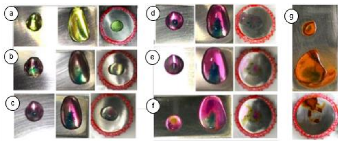
Figura 7. Modificações na superfície metálica observadas ao longo do ensaio da gota salina em função do tempo. Onde: (a) imediatamente após deposição da gota; (b) após 2 minutos; (c) após 5 minutos; (d) após 8 minutos, (e) após 13 minutos e (f) após 30 minutos.
