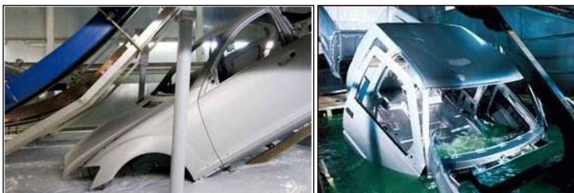
Figura 14. Carrocerias automotivas sendo mergulhadas em banheiras de zinco fundido (imagem à esquerda) em seguida submergida em banheira de cataforese para eletrodeposição de revestimento (imagem à direita), demonstrando a versatilidade dos processos de imersão à quente.
