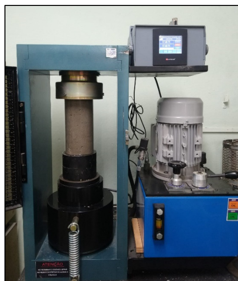
Figura 28 - Ensaio de compressão axial Fonte: Autores
