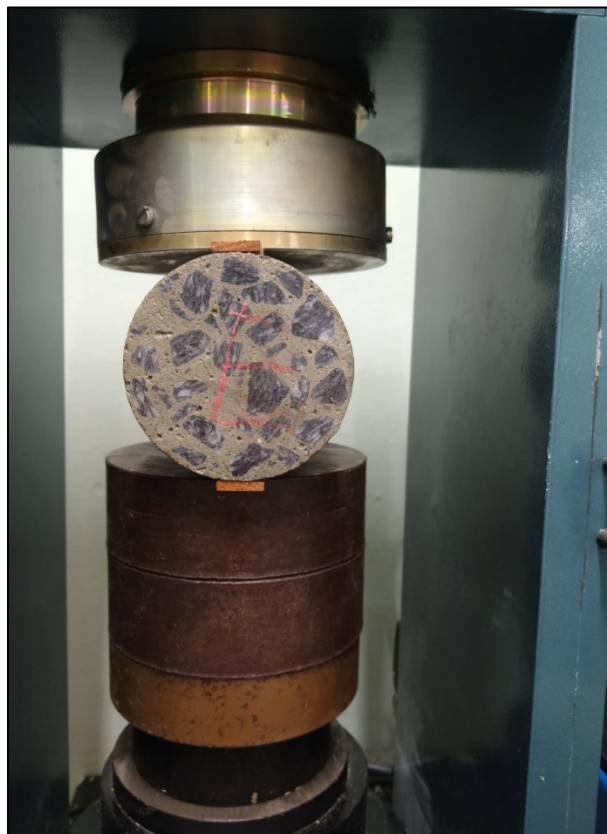
Figura 30 - Ensaio de tração por compressão diametral Fonte: Autores
