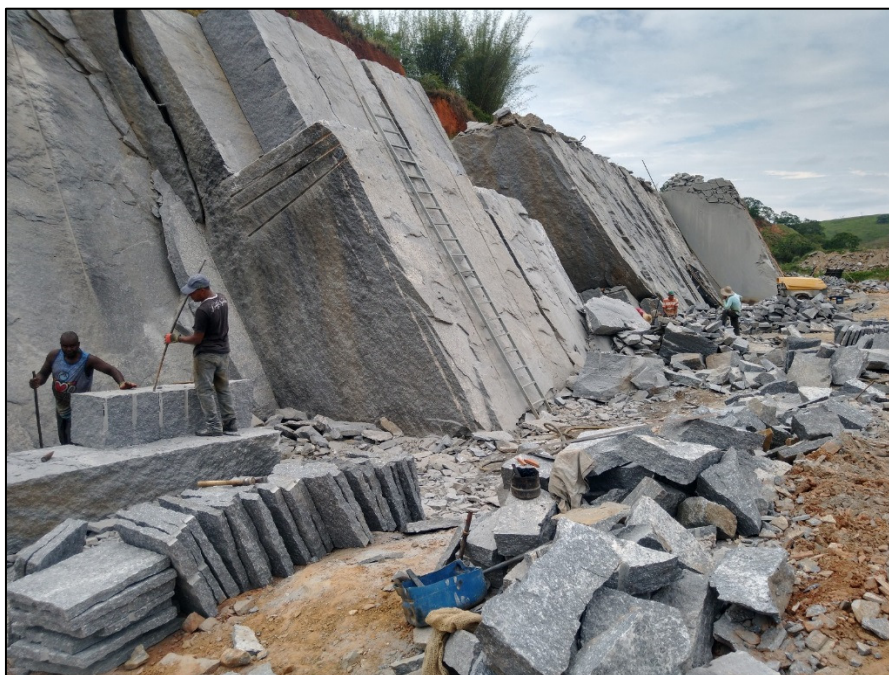
Figura 8: Redução dos maciços em blocos menores Fonte: Autores
