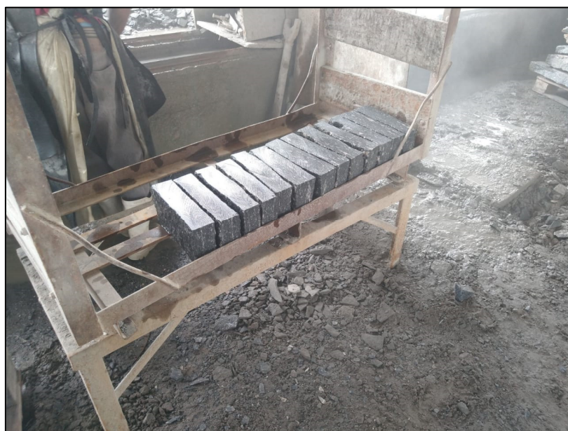
Figura 12: Resultado do corte das placas com serra Fonte: Autores
