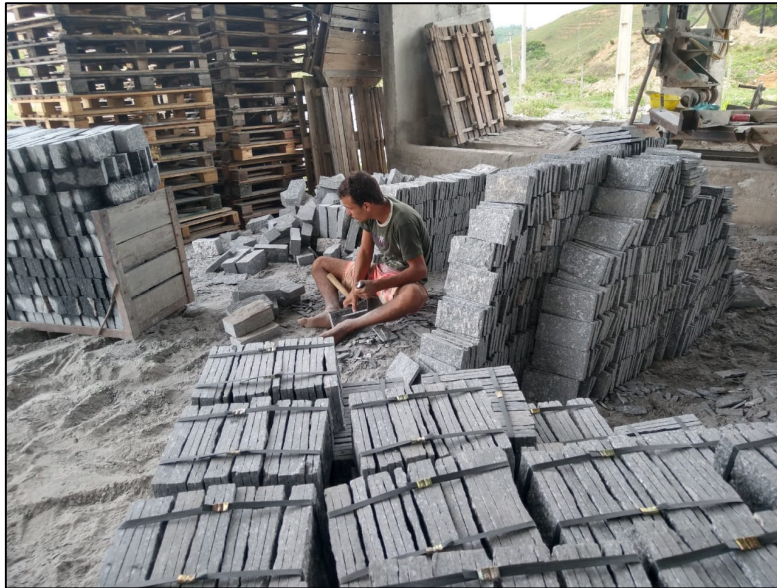
Figura 13: Fatiamento final das placas Fonte: Autores
