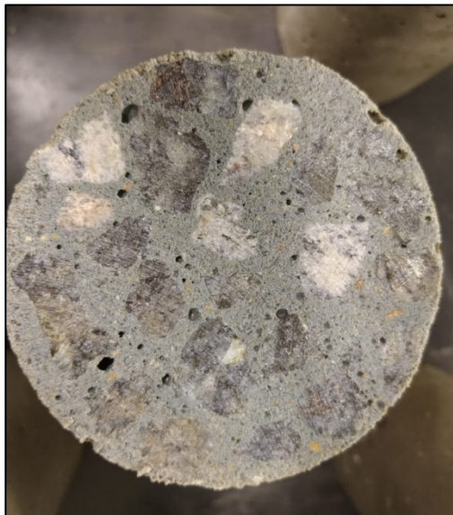
Figura 26 - Face do corpo de prova retificado - Concreto Referência Fonte: Autores
