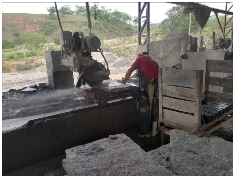
Figura 11: Beneficiamento das placas com serra Fonte: Autores
