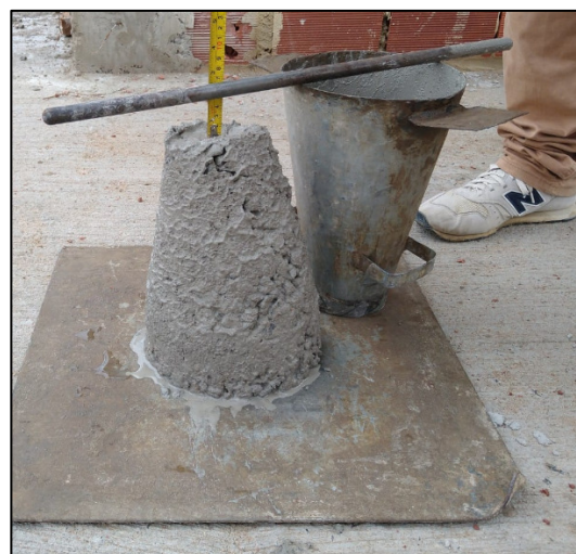
Figura 25 - Abatimento do tronco de cone - Concreto Experimental Fonte: Autores
