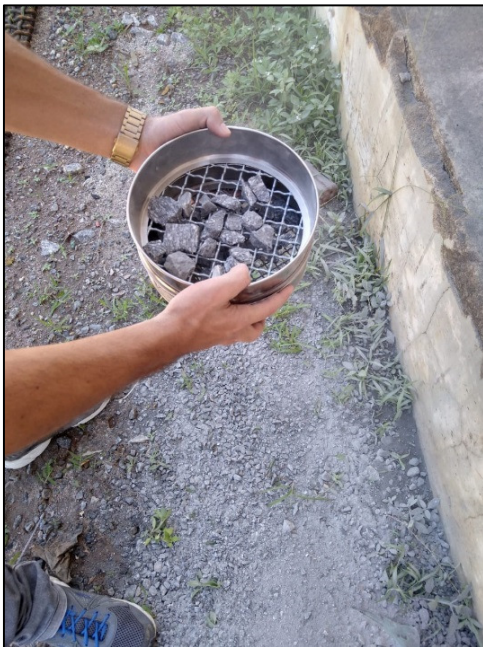
Figura 19 - Peneiramento das britas Fonte: Autores
