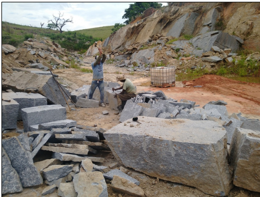
Figura 9: Redução dos blocos em placas Fonte: Autores
