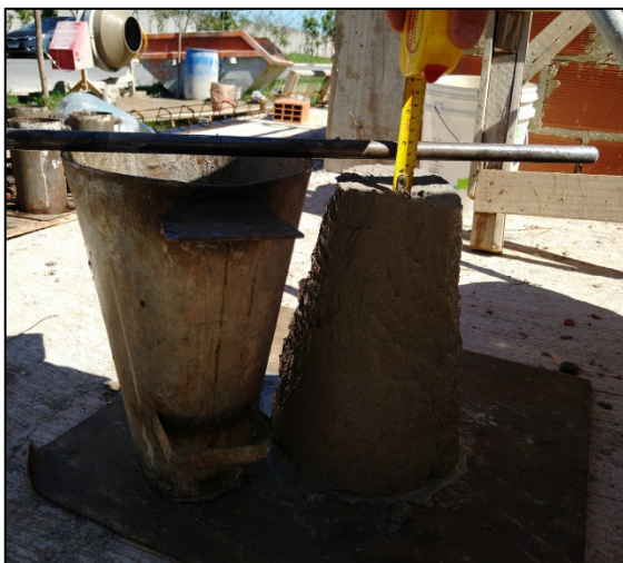
Figura 24 - Abatimento do tronco de cone - Concreto Referência Fonte: Autores
