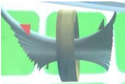
Figura 6- Objeto em RA com as respectivas linhas de campo magnético e os marcadores fiduciais (Espira condutora e as respectivas linhas de campo magnético)
