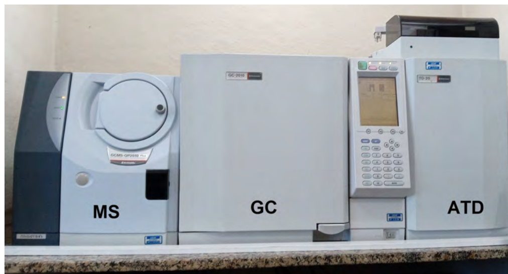
Figura 3: Equipamento de dessorção térmica automatizada acoplada a um cromatógrafo a gás com detecção por espectrometria de massa (ATD-GC/MS).
