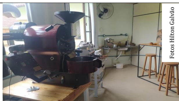
Foto 19 - Torrador capacidade 2,5 kg. Laboratório de Qualidade do Café - AlQualis Jr./IFF - Campus Bom Jesus do Itabapoana.
